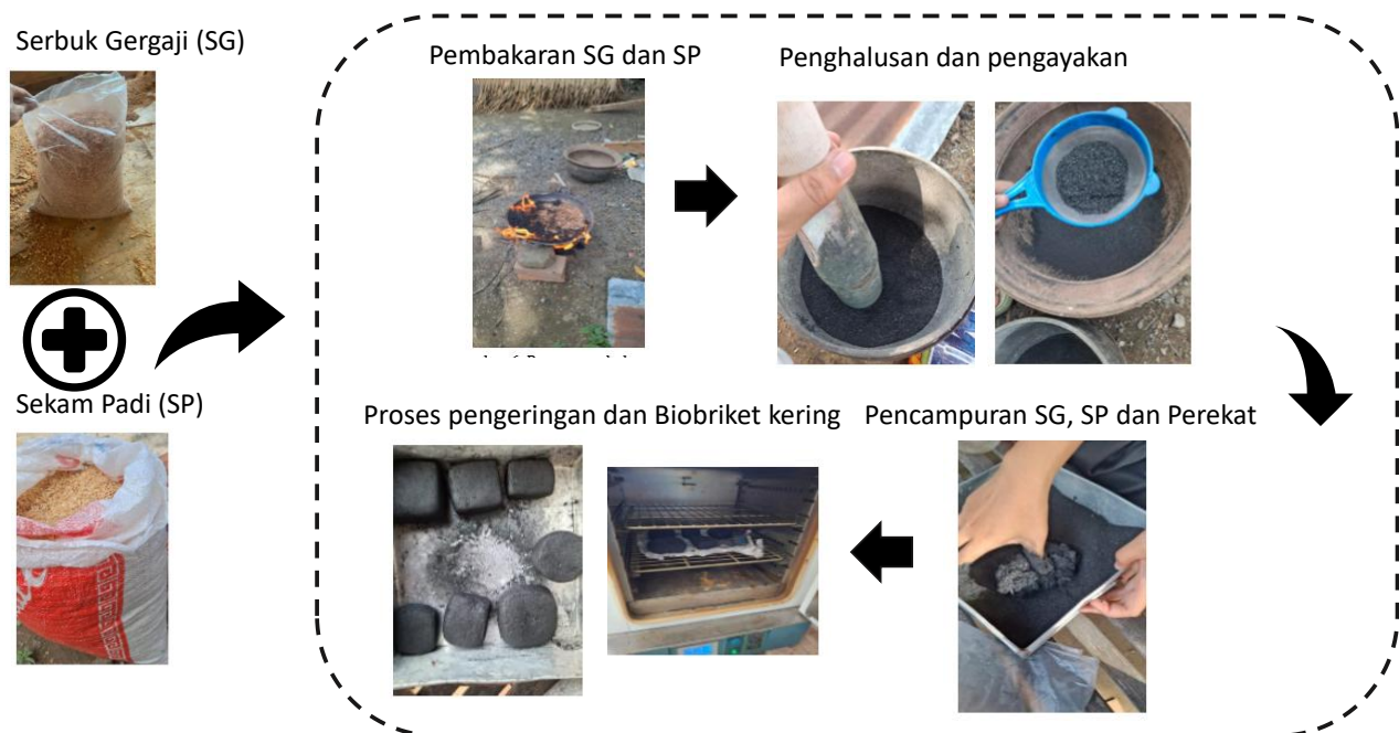
Gambar 1. Proses Pembuatan biobriket dari Serbuk Gergaji dan Sekam Padi
