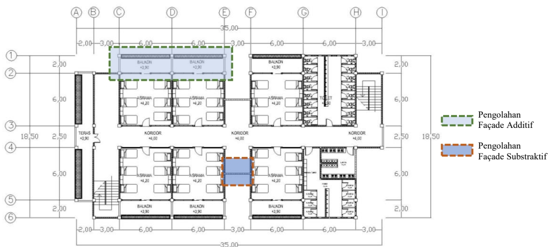
Gambar 15. Pengolahan Additif dan Subtraktif pada Bangunan
