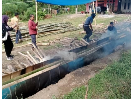
Gambar 4. Proses Pengawetan Bambu dengan Cara Direbus
