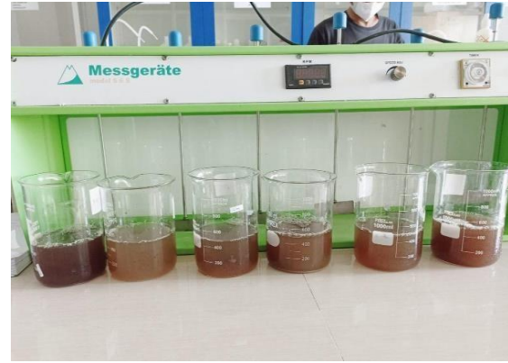
Gambar 2. Hasil limbah cair RPA setelah proses koagulasi-flokulasi dan pengendapan
