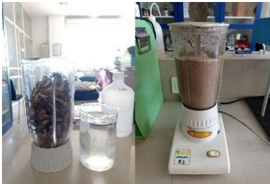
Gambar 1. Pembuatan biokoagulan ekstrak kulit singkong untuk proses koagulasi-flokulasi
